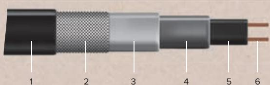
Серия CR: 1. Защитная оболочка из полиолефина (из термопласта Adflex Q100F для EHL16-2CT); 2. Экранирующая оплетка из луженой меди; 3. Второй слой изоляции из полиолефина ; 4. Первый слой изоляции; 5. Нагревательная матрица с эффектом саморегуляции; 6. Токонесущие медные жилы
