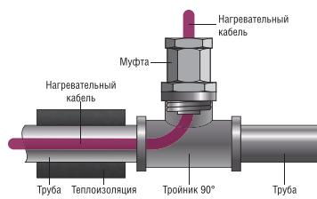
Схема 2. Монтаж муфты в тройник 90°
