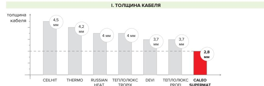
CALEO SUPERMAT — самый тонкий мат, наиболее удобен при минимальной толщине плиточного клея
