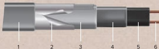
Серия AR: 1. Защитная оболочка из полиолефина; 2. Экран из алюмополиэтиленовой ленты и дренажной жилы; 3. Второй слой изоляции из полиолефина ; 4. первый слой изоляции; 5. Нагревательная матрица с эффектом саморегуляции; 6. Токонесущие медные жилы
