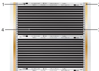
Большое значение имеет толщина и ширина медных токонесущих полос. От этого зависит величина пропускаемого ими максимального тока. А, следовательно, и максимальная длина одной полосы термопленки. Как правило — это не более 8...12 погонных метров.
