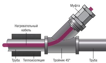
Схема 1. Монтаж муфты в тройник 45°
