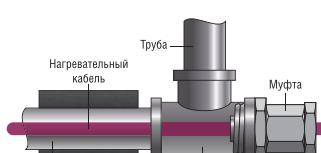
Схема 2. Монтаж муфты в тройник 90°
